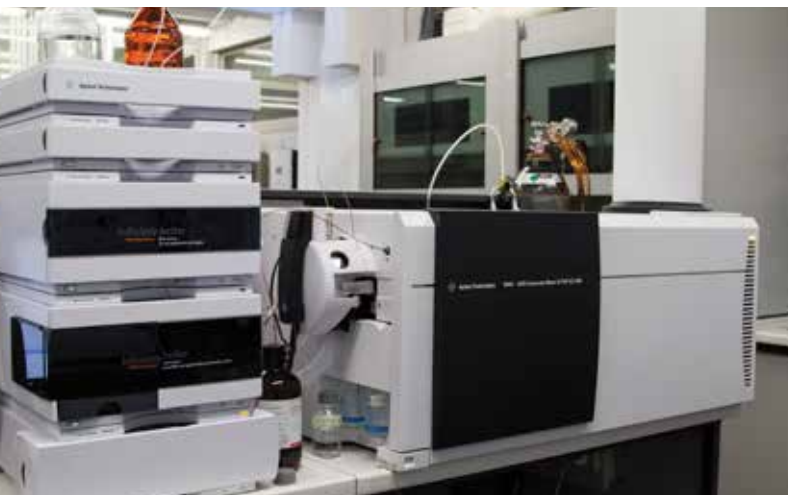
Sistema analitico di Cromatografia Liquida ad Alta Prestazione (HPLC) con analizzatore di Massa Accurata a "Tempo di Volo" (Q-TOF). Permette di effettuare analisi per determinare la eventuale presenza di sostanze polari nocive, quantificare i componenti nutrizionali di alto valore, identificare e quantificare i markers territoriali.
