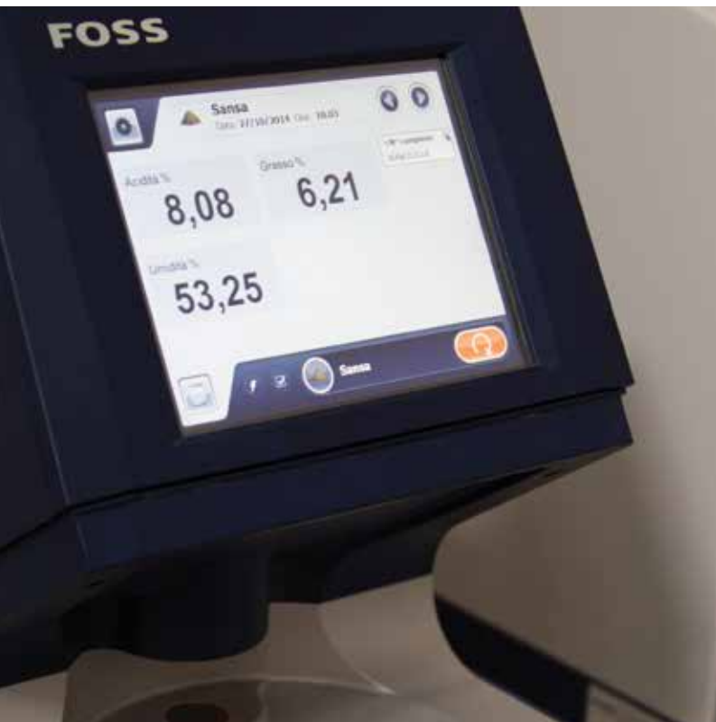
Olivia – Foss. Strumento utilizzato per valutare la qualità delle olive che fornisce informazioni accurate sul contenuto di grasso e acqua nelle olive e nella sansa.
