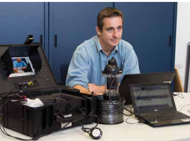
Sistema di telecamere subacquee e sonde sonar per la gestione ottimizzata del processo di alimentazione degli allevamenti ittici off-shore.
