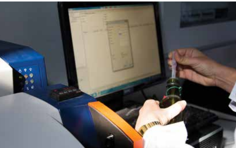
Analizzatore NIR avanzato per rapide analisi di tipo qualitativo e quantitativo sugli oli extravergini di oliva.
