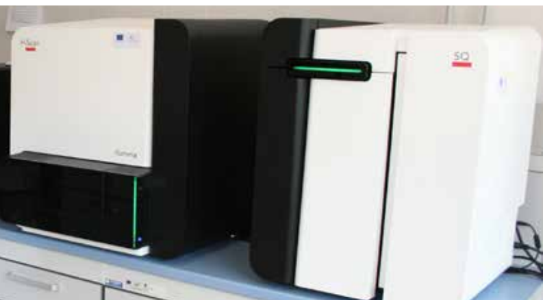
HiScan SQ – Illumina. Piattaforma che permette il sequenziamento di interi genomi e l'analisi di centinaia di migliaia di genotipi
