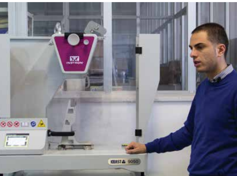
Macchina d'impatto biassiale (pendolo izod) che viene utilizzata per misurare la resistenza dei materiali impiegati nel packaging degli alimenti
