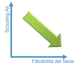
*Fig. Richiesta di aria VS filtrabilità del fango*
