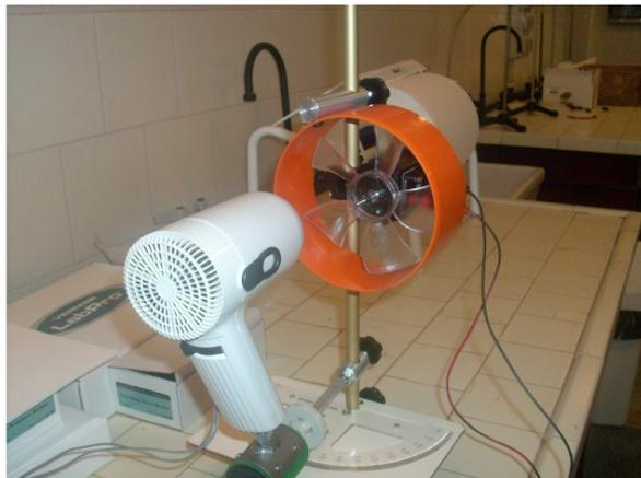
**Figura 7.2:** Apparato sperimentale per lo studio dell'energia eolica; l'apparato è costituito da un asciugacapelli, un rotore e un piccolo generatore elettrico.
