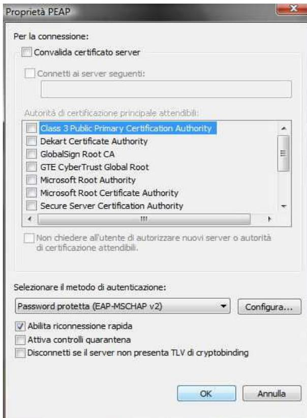
**Deselezionare** la casella nella finestra di **proprietà di EAP MSCHAPv2...** e dare **“OK”** su tutte le finestre per completare la configurazione. Ovviamente, se si possiede una scheda di rete che supporta le frequenze 802.11a sarà necessario ripetere i passi precedenti anche per la rete wifi-unipa-wpa-a
