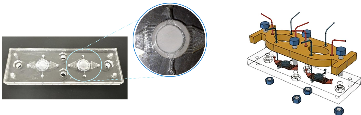
[Fig. 2] A sinistra, chip con camera di coltura e focus sulla membrana biopolimerica sulla quale i campioni di mucosa respiratoria verranno posizionati. Si evidenziano anche i circuiti di microfluidica. A destra, schema di “esplosione” del chip, per una visione dettagliata delle singole componenti.
