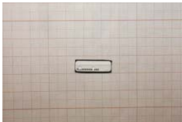
Figura A: Gocciolatore Netafim Streamline (Qn 1.5 l/h)
