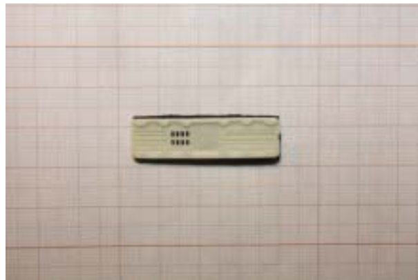
Figura A: Gocciolatore Siplast P1 (Qn 3.8 l/h)
