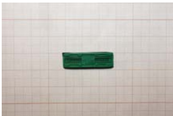
Figura A: Gocciolatore Siplast P1 Ultra (Qn 1.0 l/h)
