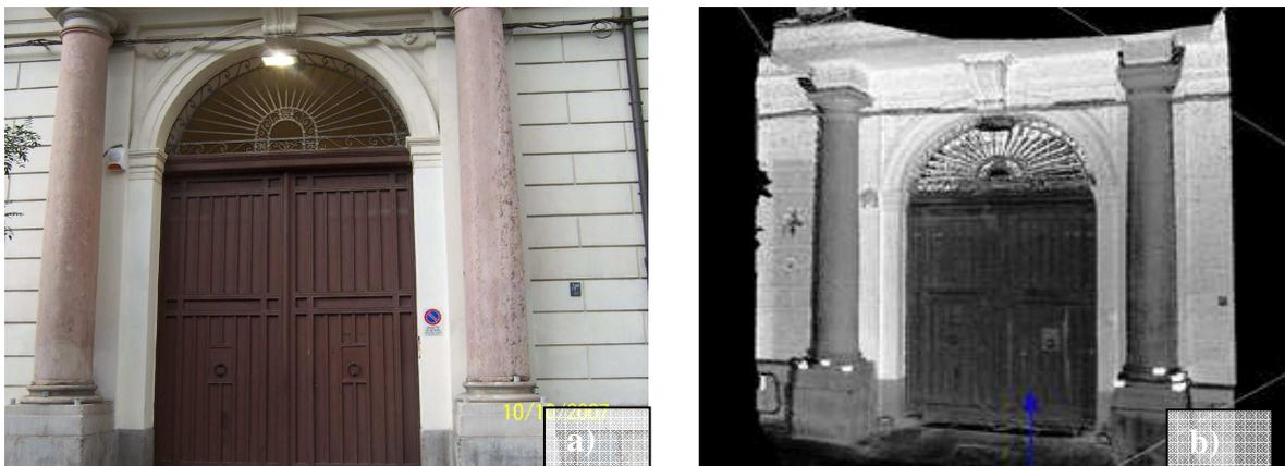
Figura 4 Zona del rilievo della riflettività: a) immagine fotografica; b) nuvola di punti dello scanner laser
