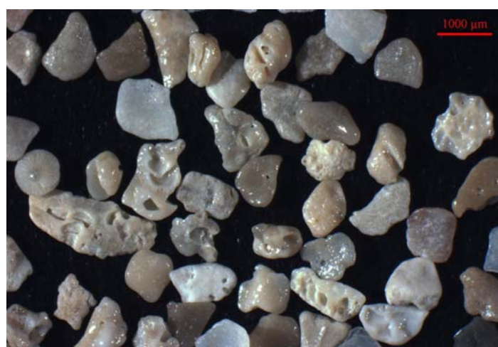
Figura 3. Sabbia carbonatica SH utilizzata nella sperimentazione. Foto al microscopio ottico: a) 0.42 \leq d \leq 0.60\text{mm} ; b) 0.60 \leq d \leq 0.84\text{mm} . Si notano sia grani di forma allungata sia prossima a quella isometrica. Gli spigoli sono sia ben arrotondati che parzialmente arrotondati e in qualche caso a spigoli vivi. Si osservano in alcuni grani pori intragranulari.
