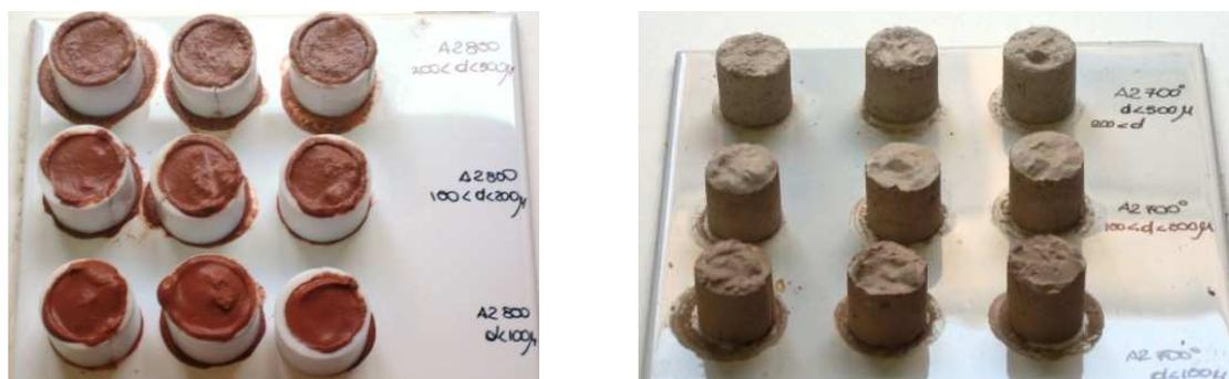
Figura 1: Preparazione dei provini di malta per le prove di compressione.
