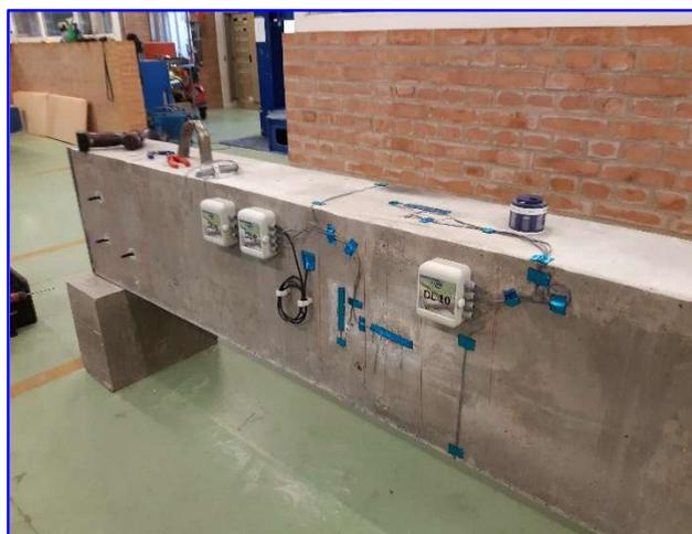
*Trave strumentata con 5 Estensimetri sul cls, 1 sulla barra. Temperatura cls, barra e aria. 3 DL e 1 Tensometer*
