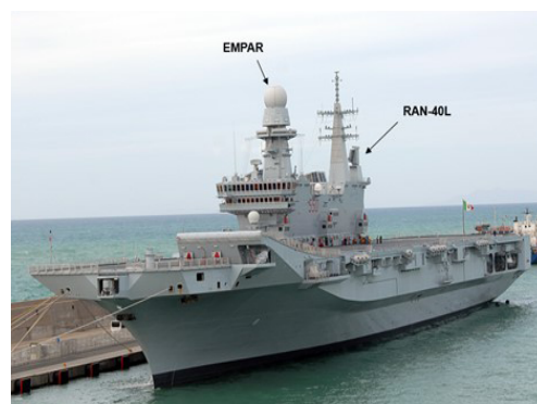
Figura 5: EMPAR installato a bordo della nave italiana "Cavour" (slide 34).
