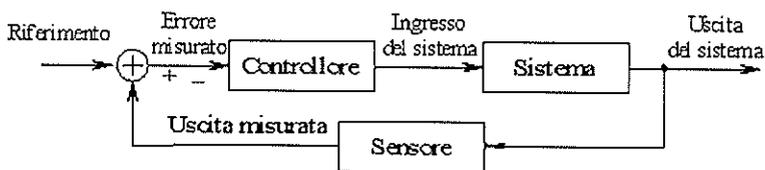
Schema di principio di un sistema controllato
