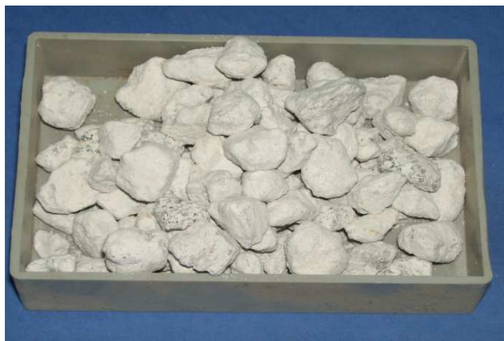
Figura 1. Materiale di partenza dal quale sono state ottenute per frantumazione le sabbie utilizzate nella sperimentazione. Le dimensioni dei “grani” sono comprese tra 10 e 15mm.
