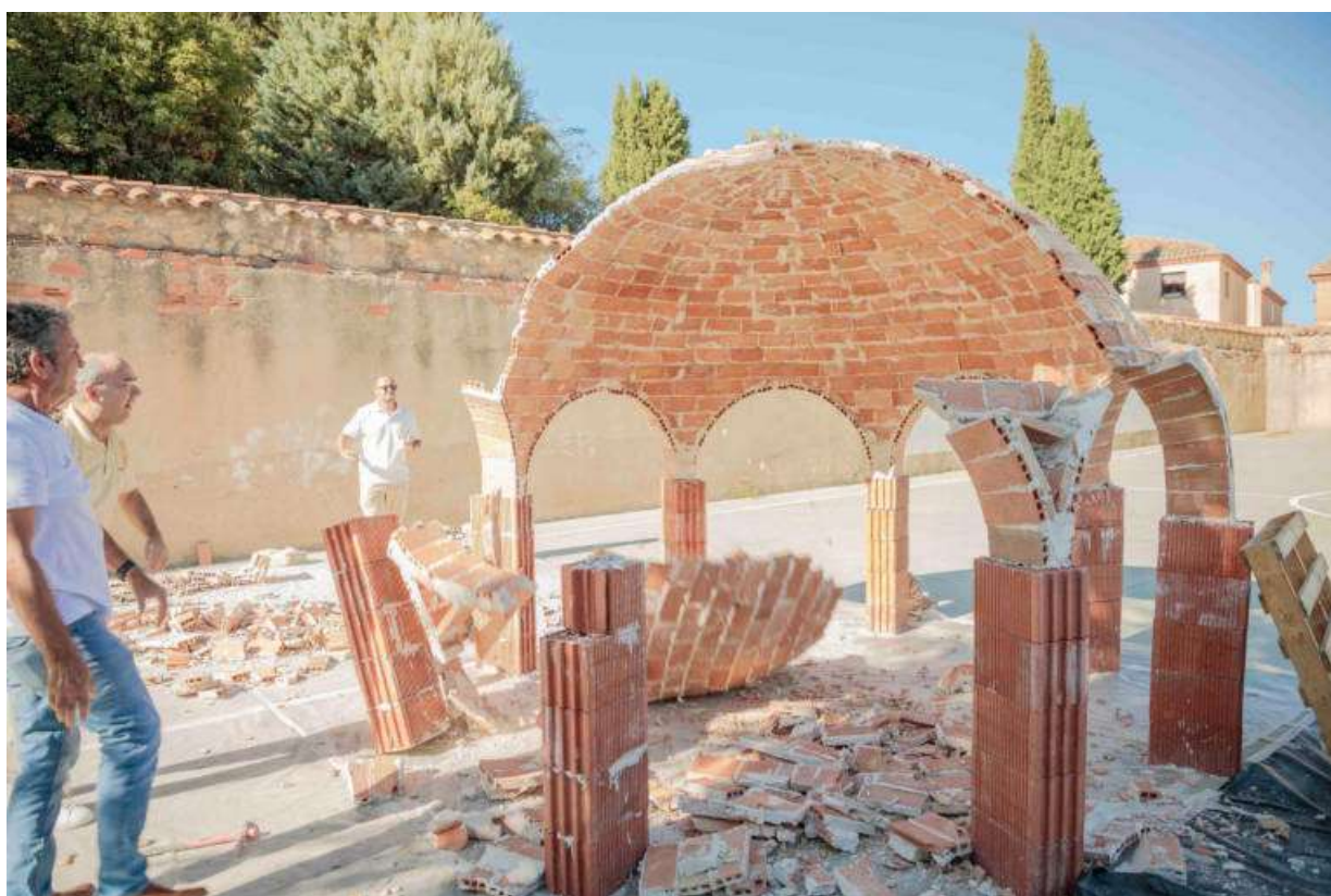
Fig. 6. La cupola durante le prove distruttive (foto di J. Arias).
