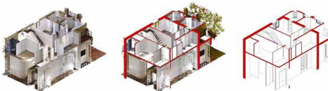
Fig. 4. Scan to BIM. Da sinistra: nuvola di punti; sovrapposizione nuvola di punti e modello BIM; modello BIM.
