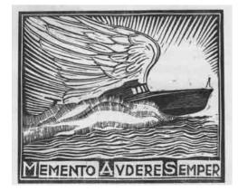
Silografia liberty di un M.A.S.: era un veloce Motoscafo Armato Silurante da 20 - 30 tonnellate di dislocamento con dieci uomini di equipaggio, armato con due siluri, bombe di profondità e una mitragliatrice. Fu impiegato anche nella seconda guerra mondiale.
