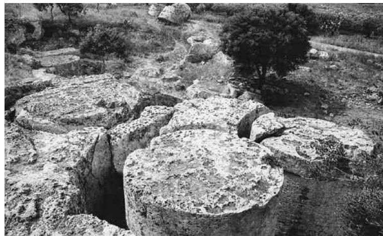
Cave di Cusa, Settore II: il banco di pietra calcarea friabile e i rocchi ancora in fase di estrazione; veduta delle fasi di estrazione dei rocchi.
