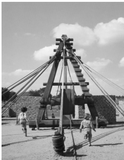
L'anfiteatro romano in fase di costruzione (1977), secondo metodi di archeologia sperimentale (da APX, Arbeitsbericht zu den Grabungen und Rekonstruktionen , 4). A destra, la capra romana usata per la ricostruzione dell'anfiteatro, ancora in mostra presso l'APX e destinata ad esperienze hands-on (foto M.C. Ruggieri Tricoli).
