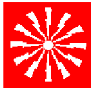
PULSANTE DI ALLARME ANTINCENDIO
