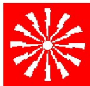
PULSANTE DI ALLARME ANTINCENDIO
