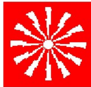
PULSANTE DI ALLARME ANTINCENDIO
