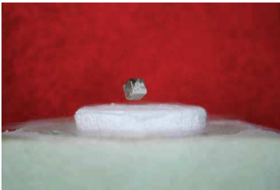
Levitazione magnetica di un piccolo magnete permanente a forma di cubo sopra un disco di superconduttore YBCO raffreddato con azoto liquido alla temperatura di 77 K. Per mantenere la temperatura stabile il disco di superconduttore è incapsulato in un cilindro di rame che a sua volta viene raffreddato con azoto liquido.
