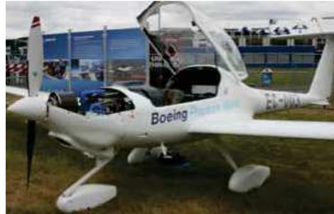
Velivolo leggero Boeing motorizzato con celle a combustibile
