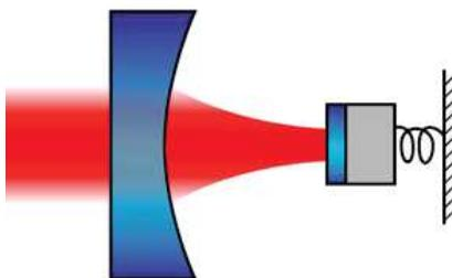
Schema di una cavità optomeccanica. La cavità consiste di uno specchio riflettente ed uno specchio mobile, ancorato armonicamente, che può oscillare.
