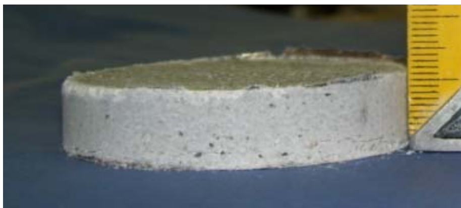
Figura 3. Provino a fine prova. Sabbia iniziale: 0.42 < d < 0.60 mm ( \sigma'_v=15 MPa). Indice di porosità iniziale e_0=3.03 . Altezza iniziale del provino: H_0=20 mm; diametro del provino: D=73 mm; altezza finale: H_{fin}=11 mm. e_f=0.75 . Si noti che il materiale presenta uno stato di addensamento e una struttura fortemente interconnessa che consente l'estrazione del provino integro dall'edometro.
