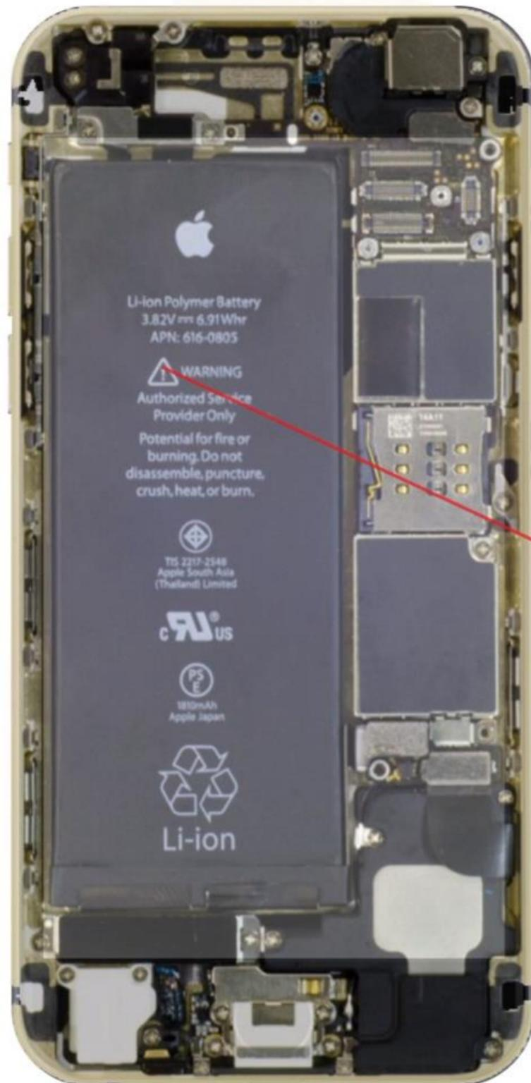
Batteria, *touch screen*, memorie a stato solido, amplificatore di potenza
