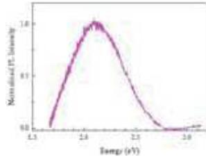
Nanoparticella di ossido di Titanio di dimensione di circa 30 nm, prodotta con la tecnica dell'ablazione laser (sinistra). Emissioni di fotoluminescenza di nanoparticelle di ossido di Zinco prodotte per ablazione laser (destra).
