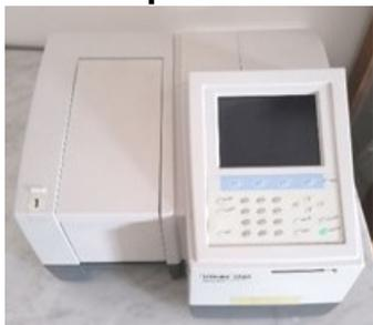
Spettrofotometro (190 to 1100 nm, risoluzione 5 nm), Shimadzu Europe – UV mini-1240
