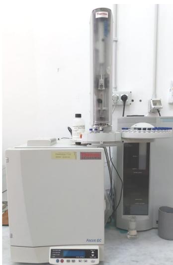
Gas-cromatografo con rivelatore ad ionizzazione di fiamma, Thermo Scientific Focus GC Gas Chromatograph
