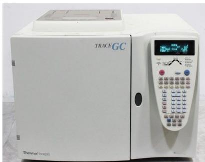
Gas-cromatografo con rivelatore a conducibilità termica (TCD) e a cattura di elettroni (ECD), Thermo Scientific Trace GC 2000 Gas Chromatograph
